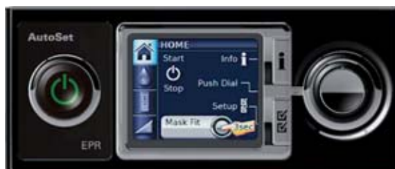
S9-laitteen näppäimistö, vasemmalla käynnistysnäppäin ja oikealla pyöritettävä säädin.
